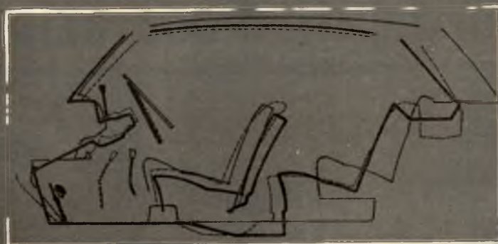
F 12:s innerutrymme i jämförelse med R8 (streckad linje) och BMC 1100 (tunn heldragen linje). Som synes är längdmått praktiskt taget identiska mellan F 12 och R8 medan BMC är längre. BMC har också bättre takhöjd. Armbågsutrymme fram är 3 cm mindre hos F 12 än hos de övriga medan det baktill är identiskt med R8:s och 1 cm mindre än BMC.
