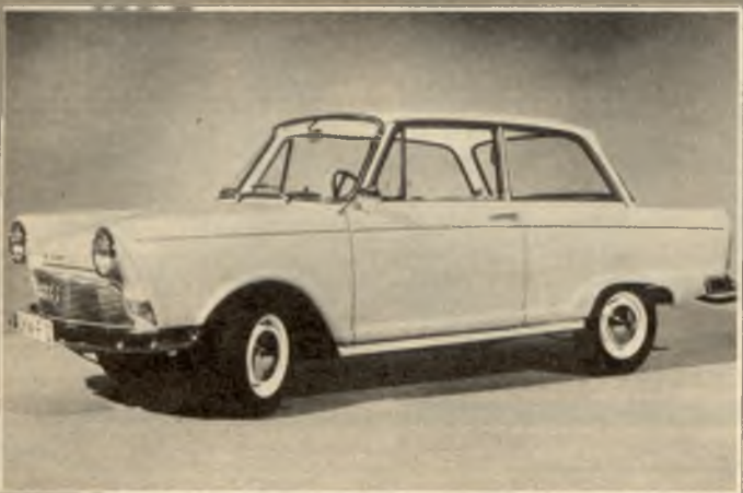
F 12 har en praktiskt lådformad kaross som ger mycket god sikt åt alla håll. I jämförelse med förra modellen har taklinjen ändrats bak så att man fått bättre takhöjd i baksätet.
